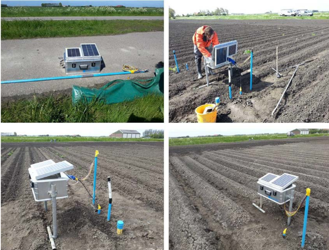
Figuur 4.9 Installatie van de ResProbes op 22 mei 2013
