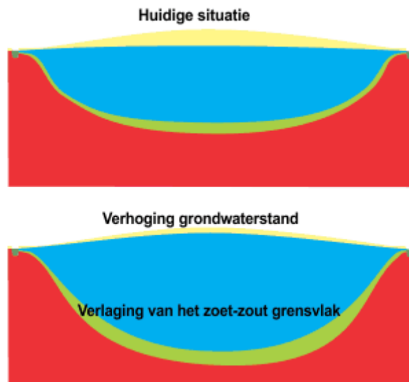
Figuur 6 Schematische weergave kreekruuginfiltratie
